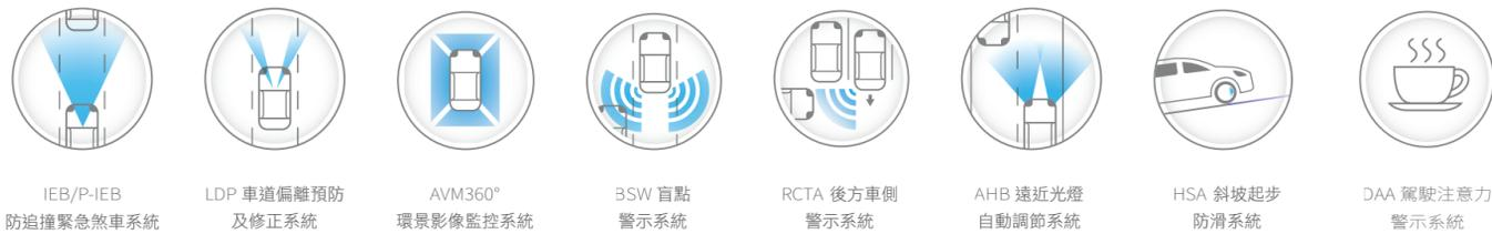
IEB/P-IEB 防追撞緊急煞車系統 | LDP 車道偏離預防及修正系統 | AVM360° 環景影像監控系統 | BSW 盲點警示系統 | RCTA 後方車側警示系統 | AHB 遠近光燈自動調節系統 | HSA 斜坡起步防滑系統 | DAA 駕駛注意力警示系統
